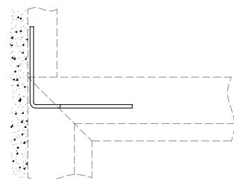
Fissaggio a pavimento
