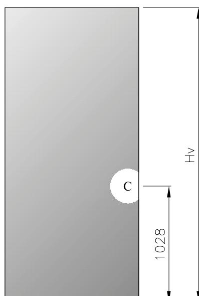
**Porte con telaio tipo FLEX**, adatte per porte sia singole che doppie. Fornitura di profili già tagliati e lavorati per la realizzazione del telaio nella misura richiesta dal cliente, completi di guarnizioni, squadrette (per giunzione e allineamento), apposite cerniere e serratura incassata oppure kit antipanico (su porta a doppia anta il dispositivo antipanico sarà installato solo sull'anta principale). Per entrambi i sistemi di chiusura non sono previste lavorazioni sul vetro.
