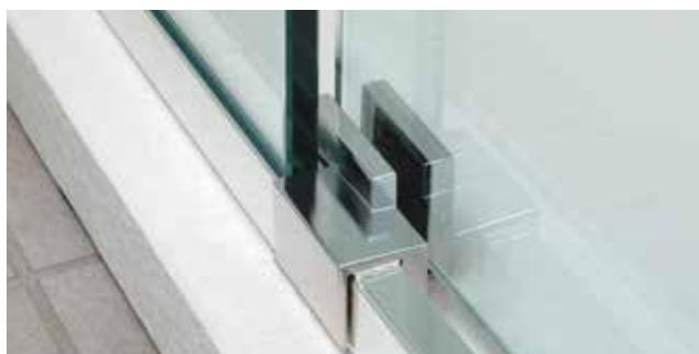
La guida a terra autoregolante integrata nella diga a pavimento, si adatta in maniera autonoma allo spessore del vetro, permettendo di ridurre al minimo le oscillazioni e le vibrazioni della porta stessa, eliminando i giochi e le rumorosità legate alle ondulazioni del vetro durante lo scorrimento. Distanza minima fra la porta scorrevole e il vetro fisso è di 11 mm.
