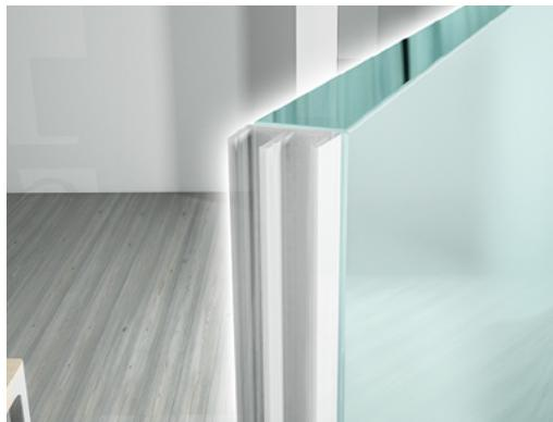
**IT** Mini Seal G-Swing è una guarnizione adesiva perimetrale per porte e pareti in vetro di semplice e veloce installazione che chiude le fastidiose fessure attorno alle porte in vetro. Le labbra morbide sono accorciabili a strappo e permettono la chiusura di fessure da 2,5 fino a 7mm, su vetri di spessore da 8 a 14mm.
