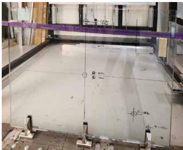
I supporti sono fissati con 4 attacchi M12 per ogni supporto.
