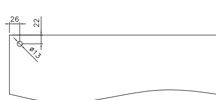
Lavorazione su vetro fisso 90° Glass processing on 90° fixed glass panel
