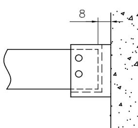
Fissaggio regolabile a muro
