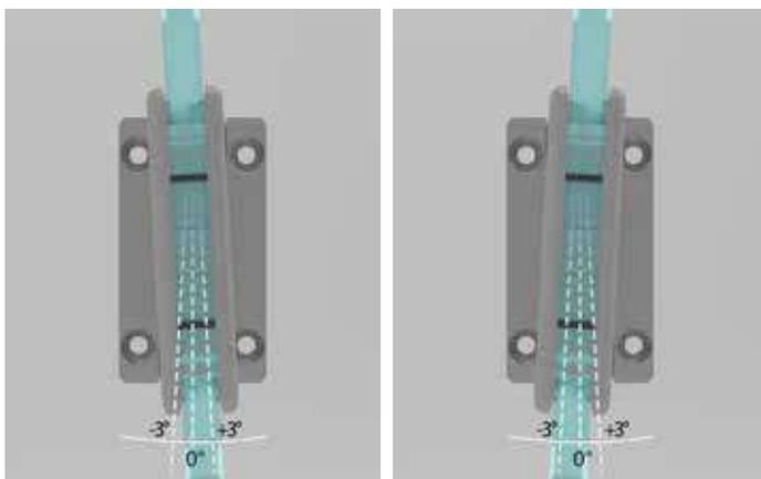
Tutte le regolazioni si effettuano con anta già installata senza necessità di smontare nessun componente della cerniera
