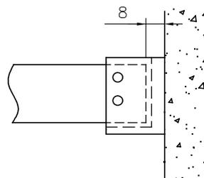
Fissaggio regolabile a muro
