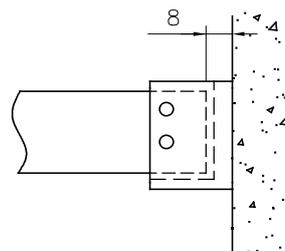
Fissaggio regolabile a muro
