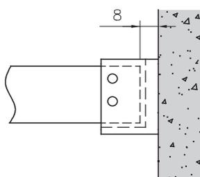
Fissaggio regolabile a muro
